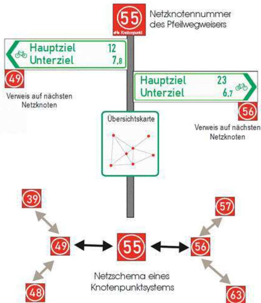
Abbildung 5-14: Elemente des Knotenpunktsystems am Standort und als Netzschema
