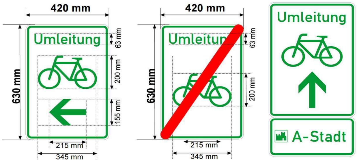
Abbildung 5-20 Umleitungstafeln und Zwischenwegweiser bei großräumigen Umleitungen
