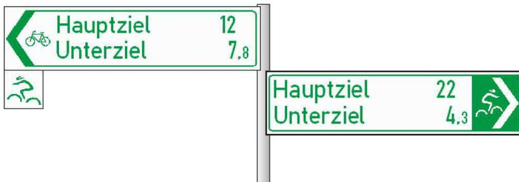
Abbildung 5-22: Pfeilwegweiser der MTB-Wegweisung und der allgemeinen Fahrradwegweisung an einem Pfosten
