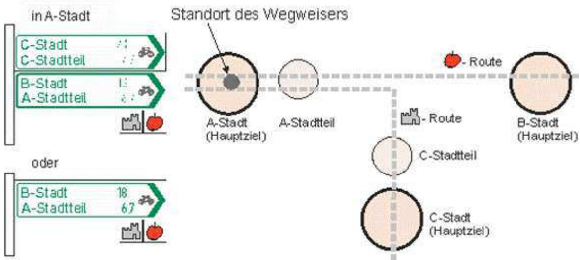
Abbildung 4-2 Parallelführung von zwei Hauptzielen
