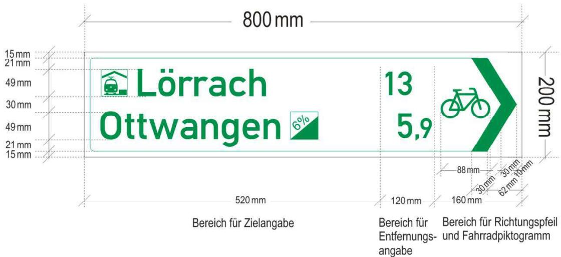
Abbildung 5-5 Pfeilwegweiser „Standardtyp“ 800 X 200 mm (rechtsweisend)
