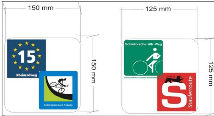
Abbildung 5-11 Darstellung von Kombiplaketten bei paralleler Streckenführung
