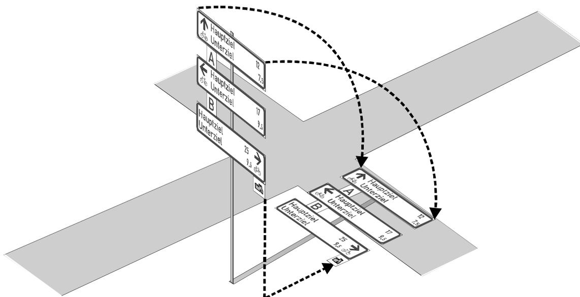
Abbildung 5-2 Anwendung der Umklappregel an einer Straßenkreuzung
