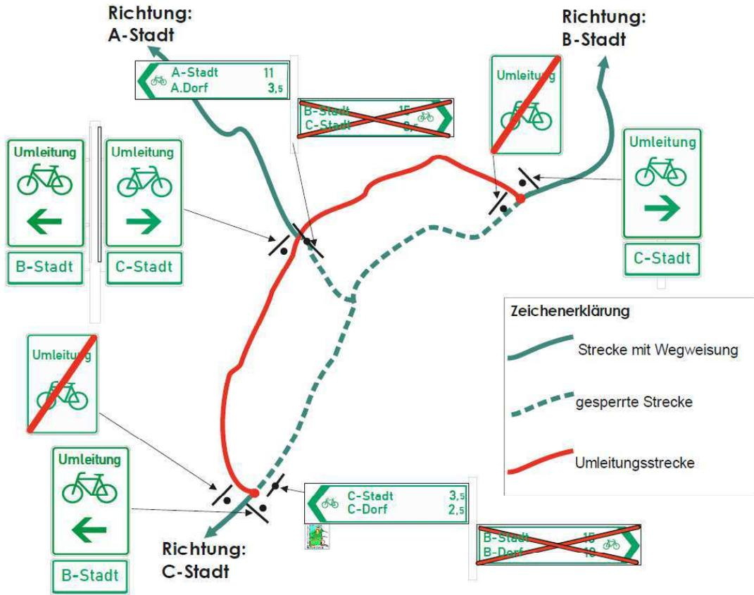
Abbildung 5-19 Grundkonzept einer großräumigen Umleitungsbeschilderung
