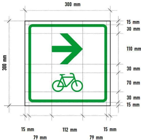
Abbildung 5-3 Standardmaße für Zwischenwegweiser
