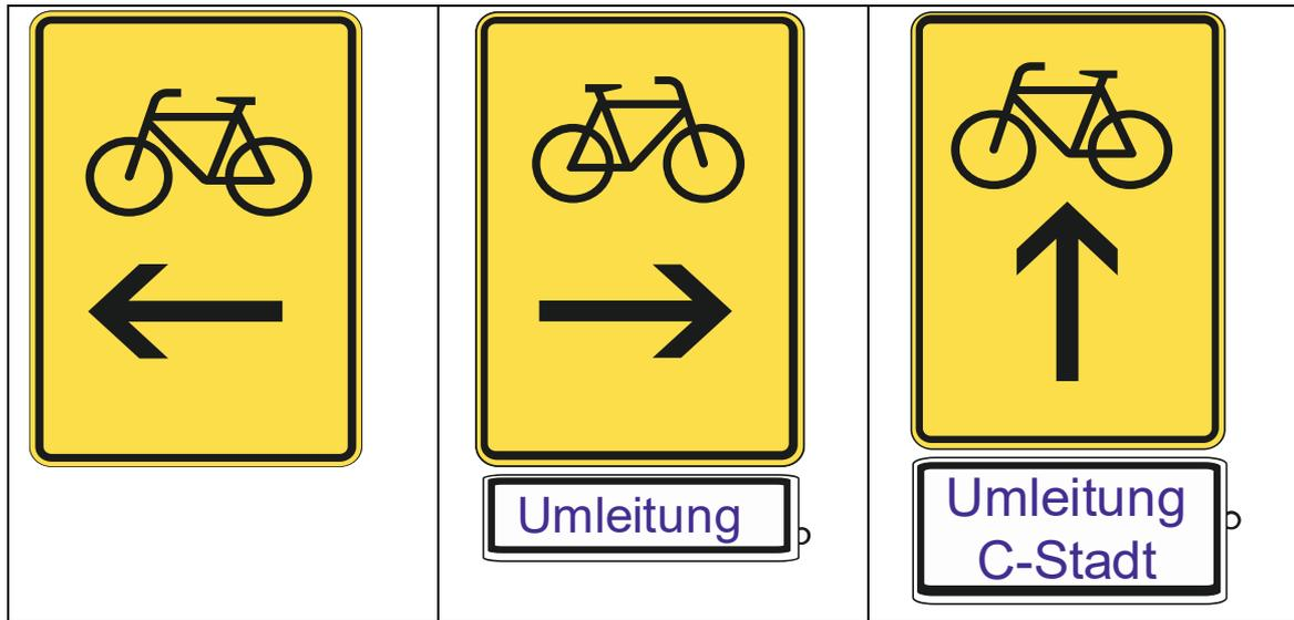
Abbildung 5-21 Umleitungsbeschilderung auf der Basis von Zeichen 442 für kleinräumige Baustellenführung
